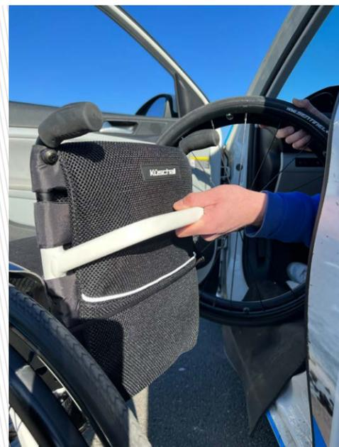
Der hohe Rückenbügel lässt sich dank Kantrrohr super greifen. Er befindet sich auf optimaler Höhe, um das Auseinander-, Zusammenbauen und Verladen deutlich zu vereinfachen.
