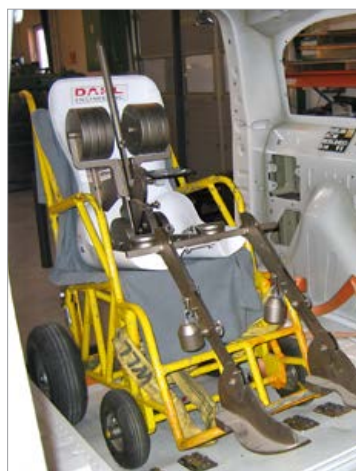
ECE regulative 17 Mesure du point H
