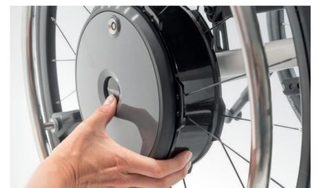
Un bouton d'axe à démontage rapide permet de monter et de démonter les roues e-motion en un tour de main.
