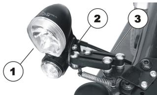
Desserrez et retirez l'écrou (2).
