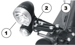
Desserrez l'écrou (2) à l'aide d'une clé à fourche de 7 mm et d'une clé Allen de 3 mm.
