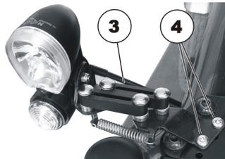
Desserrez et retirez les vis (4) à l'aide d'un tournevis TX25.
