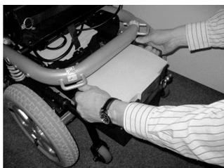
Tirez le bloc batterie avant vers l'arrière à l'aide de la sangle et ressortez-le à l'aide des poignées.
