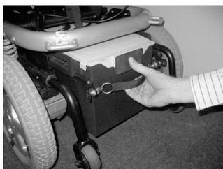
Tirez le bloc batterie arrière vers l'arrière à l'aide de la sangle. Le dispositif de blocage s'ouvre automatiquement.
