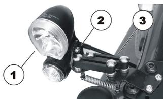
Desserrez et retirez l'écrou (2).
