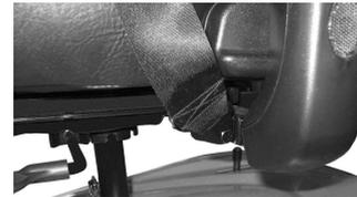
Répétez les étapes 1 et 2 de l'autre côté du siège avec l'autre extrémité de la ceinture de maintien. Assurez-vous que l'écrou est bien serré sur le boulon.
