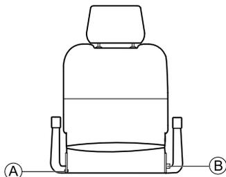
1. Retirez la vis (A) sur un côté du siège.
