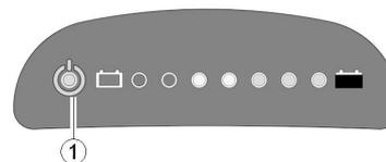
**i** La diode ON/OFF (1) sert à signaler les dysfonctionnements (affichage de l'état). Elle clignote en présence d'un problème sur le scooter. Le nombre de clignotements indique le type d'erreur. Reportez-vous à la section *11.1.2 Codes d'erreur et codes de diagnostic*, page 65.
