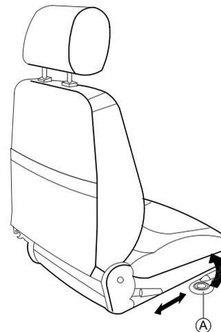
1. Tirez le levier **A** pour déverrouiller le siège.
