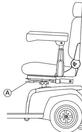
Tirez sur le levier de déverrouillage A.
