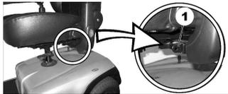
Les supports de montage (1) permettant de fixer la ceinture sont situés sous le siège (la figure ne montre que le côté gauche).
