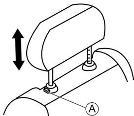
1. Pour rehausser l'appui-tête, appuyez sur le bouton de déverrouillage **A** et soulevez l'appui-tête jusqu'à la position souhaitée.
