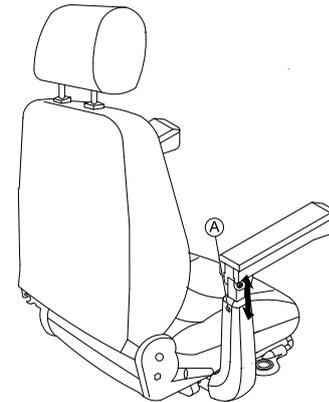
1. Desserrez et retirez la vis de fixation de l'accoudoir Ⓐ.
