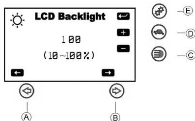
Appuyez sur les touches de clignotant (A) ou (B) pour régler l'intensité du rétro-éclairage.
