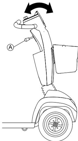
1. Poussez le levier **A** vers le bas pour régler la colonne de direction.
