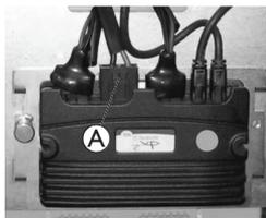
Retirez le câble de batterie **A** du module d'alimentation.
