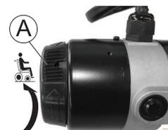
1. Tournez le bouton rotatif (A) dans le sens inverse des aiguilles d'une montre. Le moteur est embrayé.
