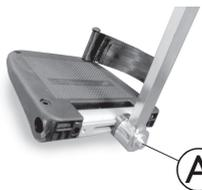
1. Desserrez la vis de réglage du repose-pieds **A**.
