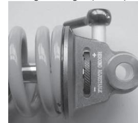
Le réglage d'usine de la molette est en position centrale. À partir de là, l'absorption de chocs peut être ajustée pour être plus douce (-) ou plus dure (+) sur 10 niveaux dans les deux sens.
