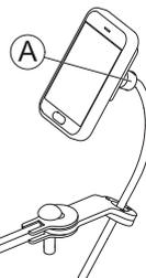
1. Desserrez la douille de serrage **A**.
