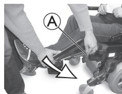
1. Maintenez le repose-jambes dans la zone du repose-pieds, tirez le levier de réglage latéral **A** et abaissez lentement le repose-jambes.
