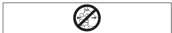
Keine Seitenkräfte auf den Verstellmotor ausüben (z. B. durch Verwendung einer Schiebestange), da dies zu Beschädigungen und Fehlfunktionen führen kann.
